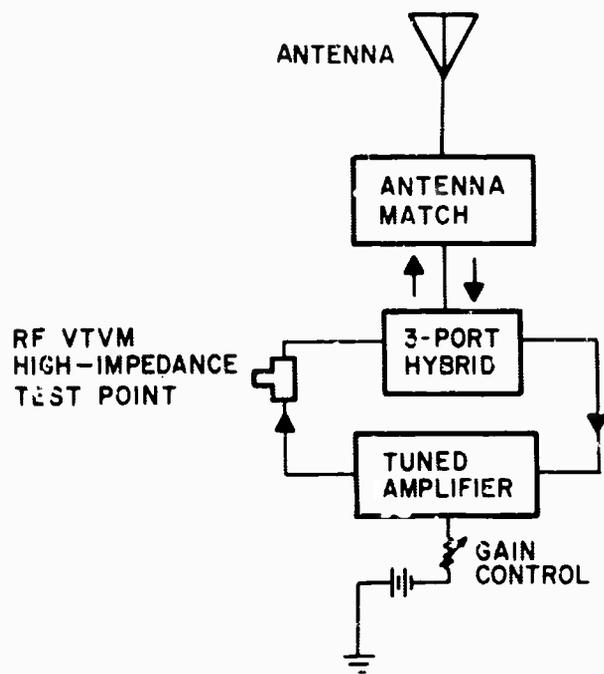
FIGURE 15. WIDE-BAND REPEATER SYSTEM TEST (FIELD)
