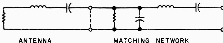
FIGURE 30. FINAL MATCHING NETWORK FOR WIDE-BAND RECEIVER
