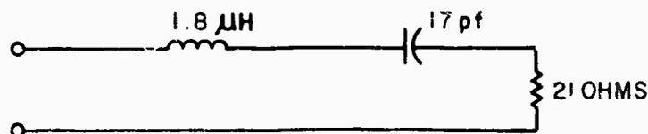
FIGURE 26. MONOPOLE ANTENNA EQUIVALENT CIRCUIT
