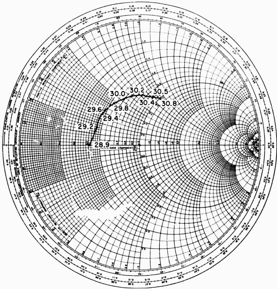
FIGURE 24. SMITH-CHART PLOT OF MONOPOLE ANTENNA IMPEDANCE VS FREQUENCY
