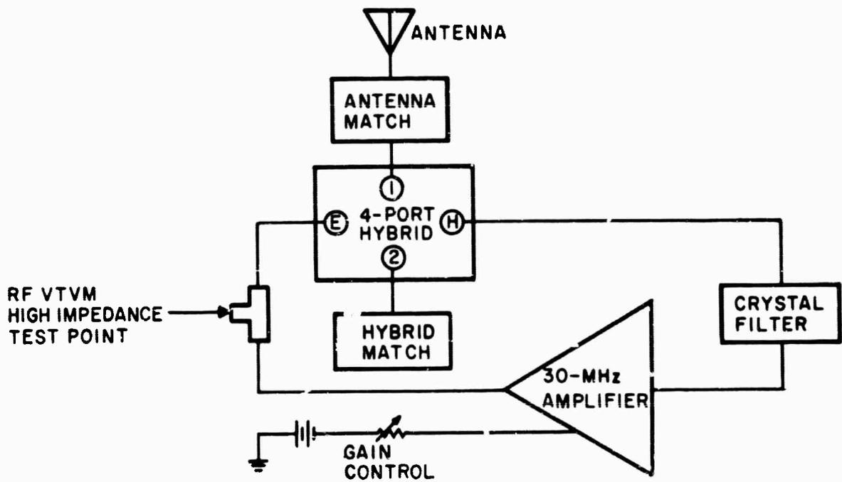
FIGURE 14. HIGH-GAIN REPEATER SYSTEM TEST (FIELD)
