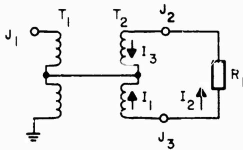
FIGURE 36. HYBRID CIRCUIT
