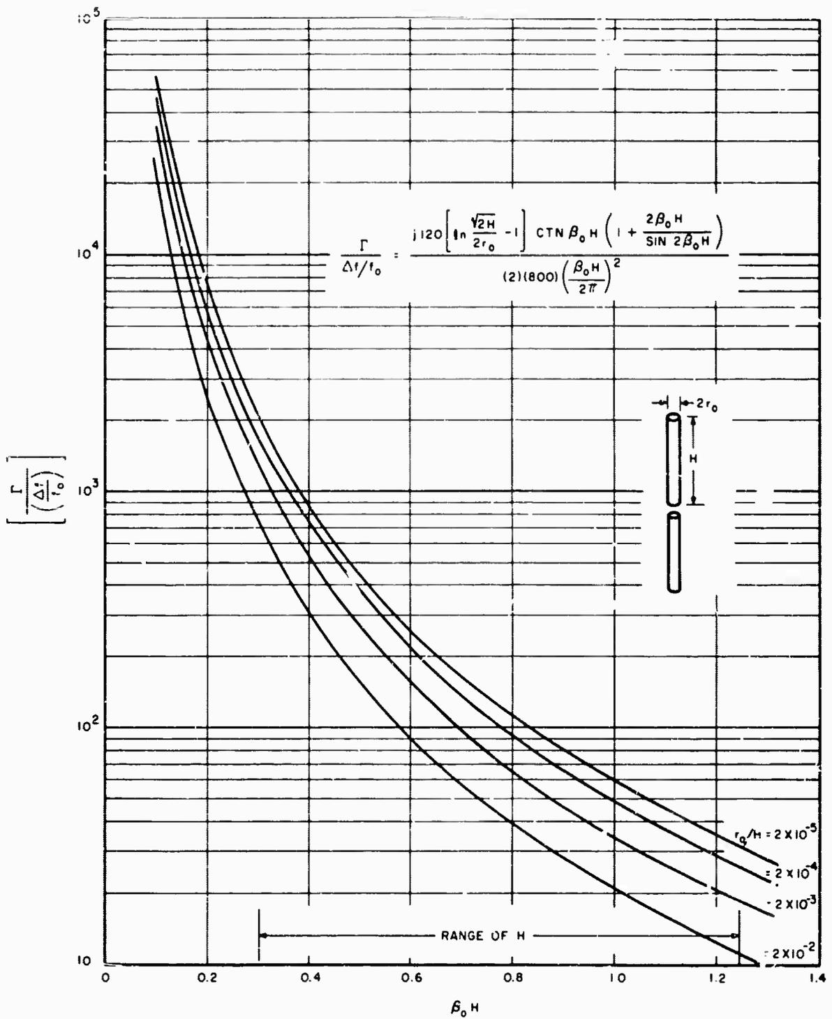
FIGURE 21. NORMALIZED REFLECTION COEFFICIENT VS ANTENNA LENGTH
