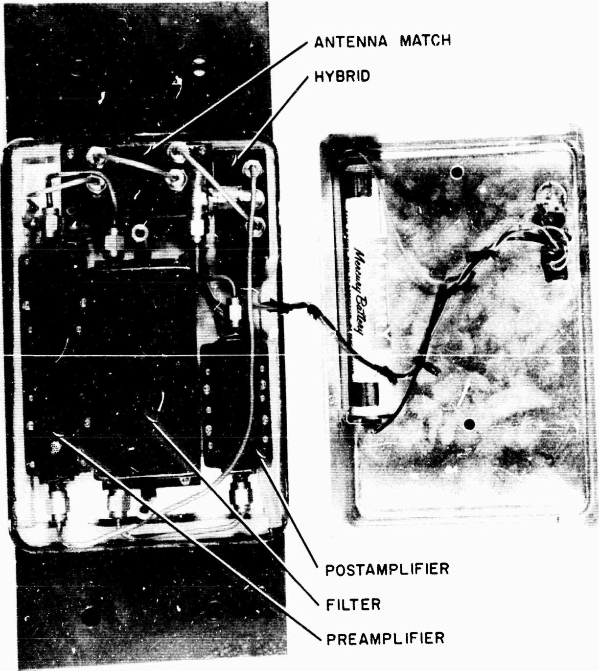
FIGURE 7. WIDE-BAND REPEATER ELECTRONIC PACKAGE (LAYOUT)
