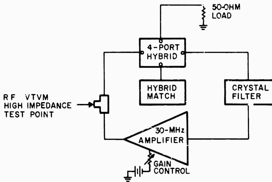
FIGURE 13. HIGH-GAIN REPEATER SYSTEM TEST (BENCH)
