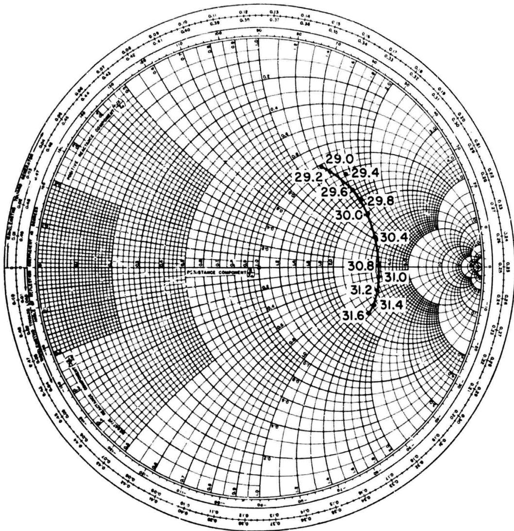
FIGURE 34. SMITH-CHART PLOT FOR DISCONE ANTENNA IMPEDANCE VS FREQUENCY
