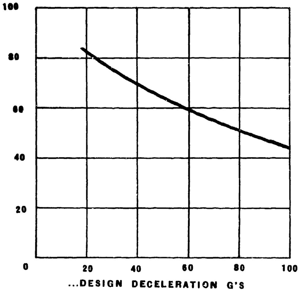
**FIG 9. TYPICAL VARIATION IN CRUSHING OF 80/0/½ PAPER HONEYCOMB WITH DESIGN DECELERATION G's**
