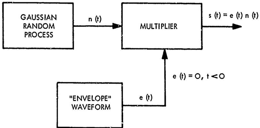
FIGURE 1. IDEALIZED MODEL OF WAVEFORM GENERATION.
