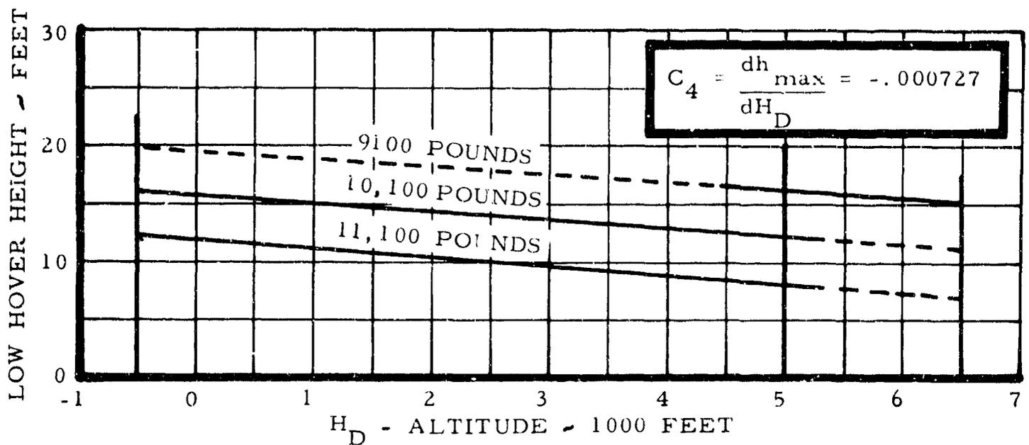
FIG. 16 LOW HOVER HEIGHT ( $h_{\max}$ ) VERSUS TEST ALTITUDE FOR THE RANGE OF TEST WEIGHTS
