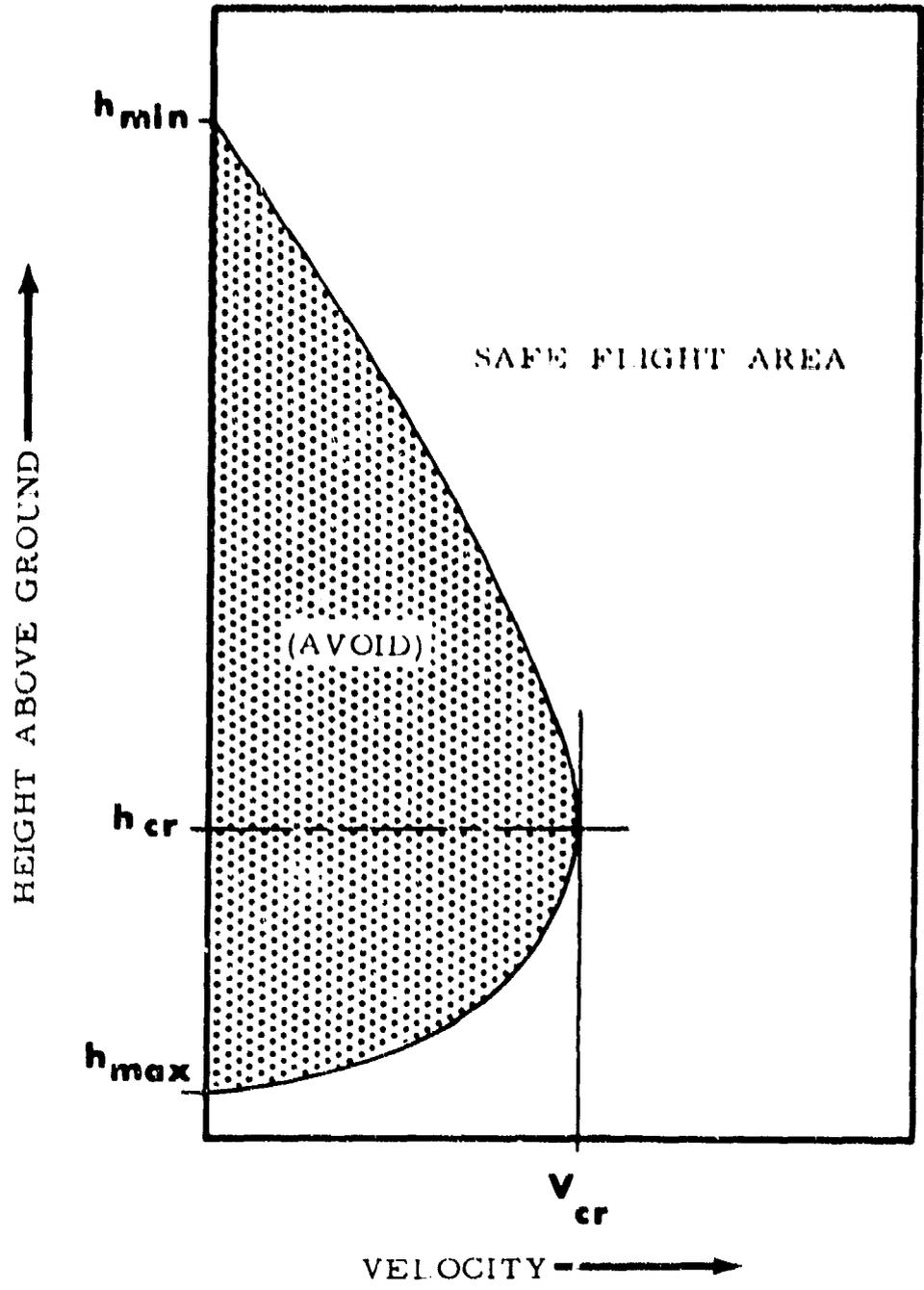
FIG. 1 TYPICAL HEIGHT-VELOCITY DIAGRAM
