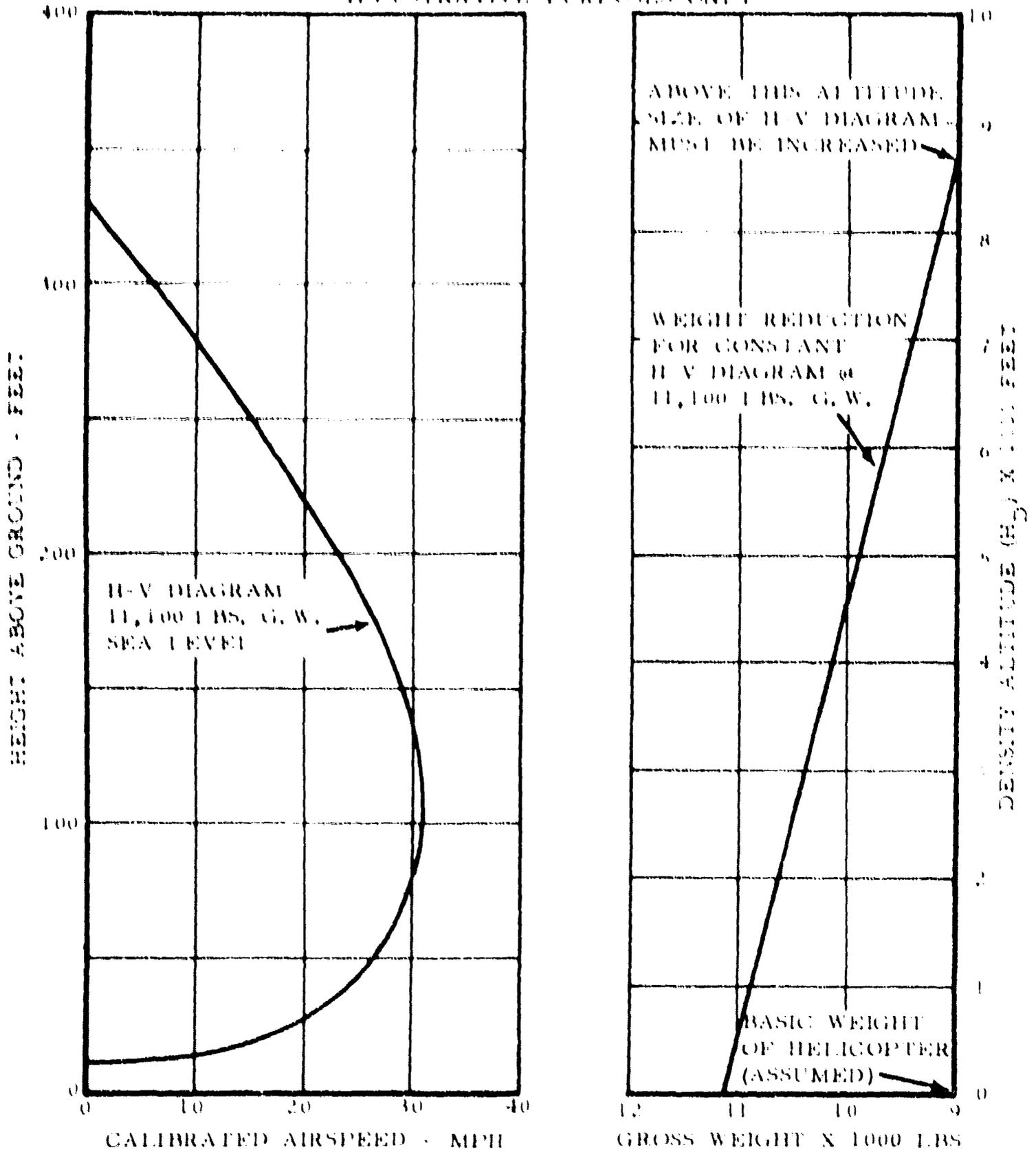
FIG. 18 CONSTANT HEIGHT VELOCITY DIAGRAM
