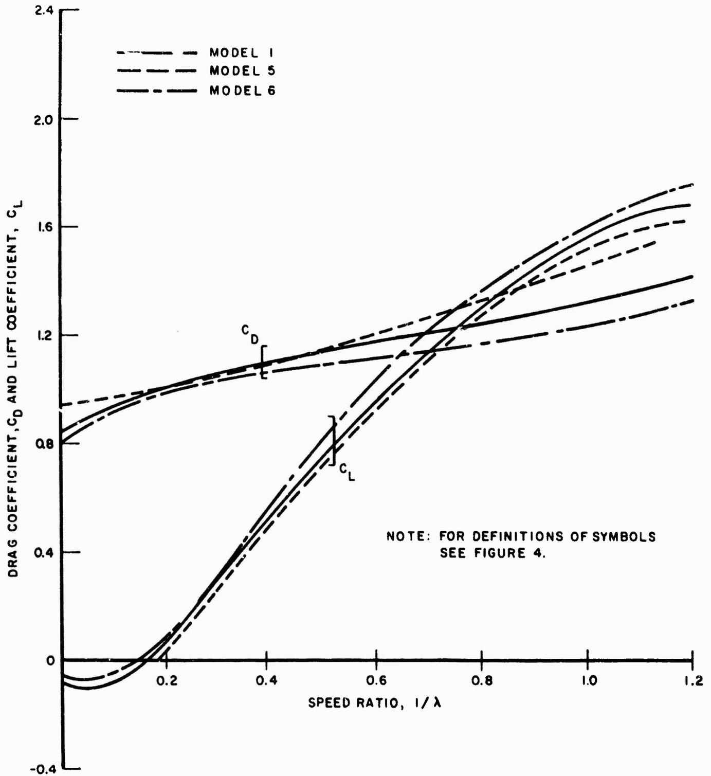
FIGURE 6. EFFECT OF ROTOR HEIGHT ON DRAG AND SIDE FORCE OF SAVONIUS ROTORS
