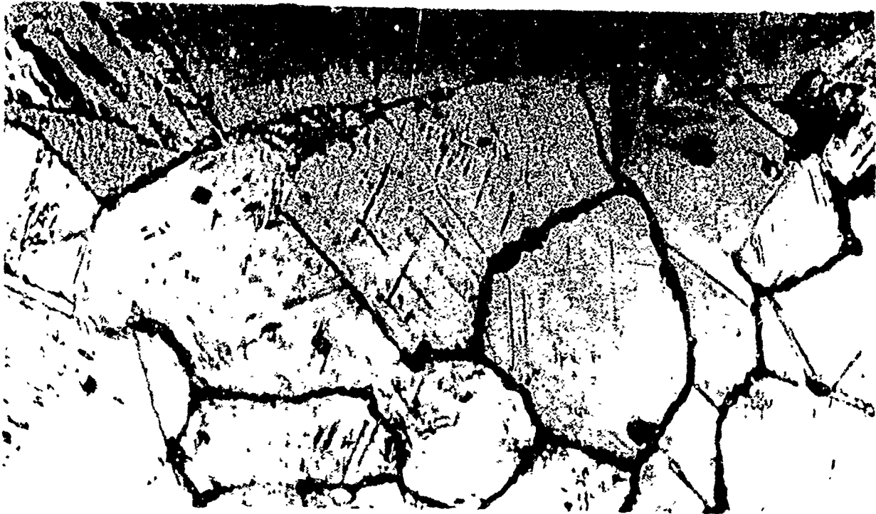
FIG. 27 Mesmo aço da Fig. 26. Grãos de austenita e carbonetos em contornos de grão. Corrosão intergranular na parte inferior. Secção transversal. Ataque: água+régia. Ampliação de 1000 diâmetros.
