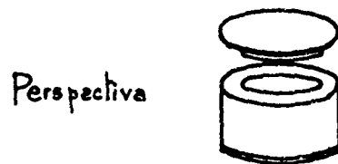
Fig. 5 Matriz para Sinterizado sin Compresión, sólo Calefacción
