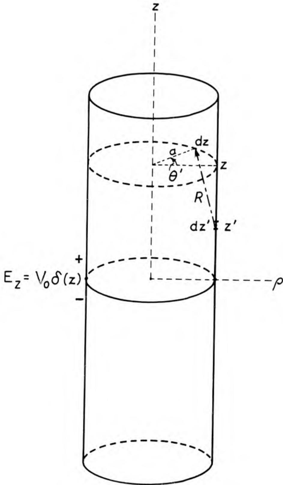
FIG. 3 THEORETICAL MODEL OF ELECTRICALLY THICK ANTENNA DRIVEN ON OUTSIDE SURFACE ONLY BY DELTA-FUNCTION GENERATOR.
