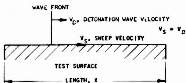
(a) WAVE PROPAGATING PARALLEL TO TEST SURFACE
