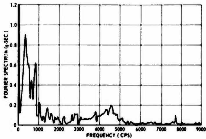
Fig. 21. Fourier amplitude spectrum -- test 2, accelerometer 9R
