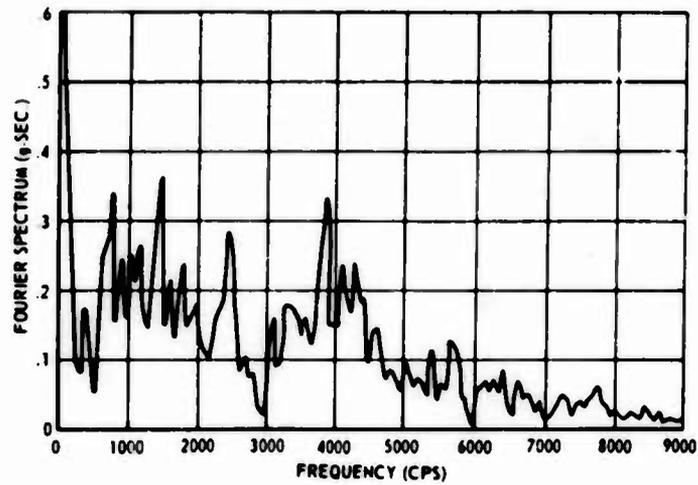
Fig. 20. Fourier amplitude spectrum -- test 2, accelerometer 9L
