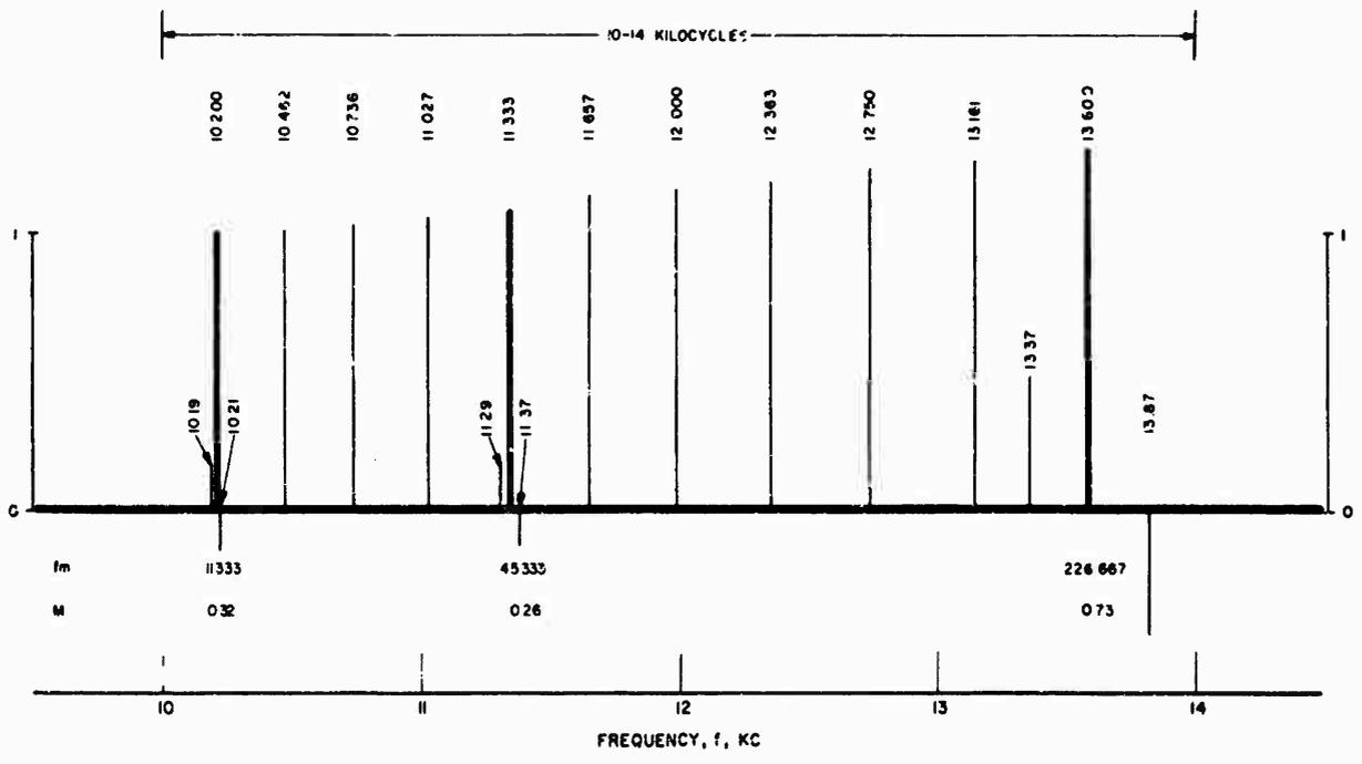
FIG. 4.6-1 OMEGA SYSTEM SIGNAL SPECTRUM
