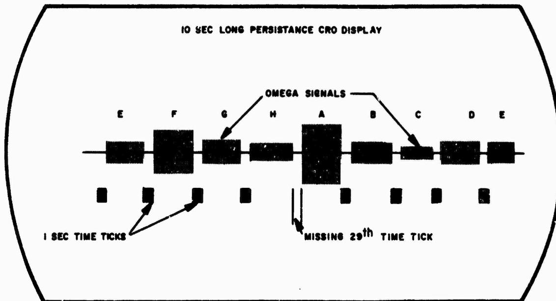
FIGURE 2.3-4. STATION IDENTIFICATION BY STANDARD TIME
