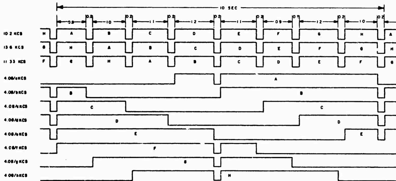
FIG. 4.1-1 OMEGA RECEIVED SIGNAL FORMAT
