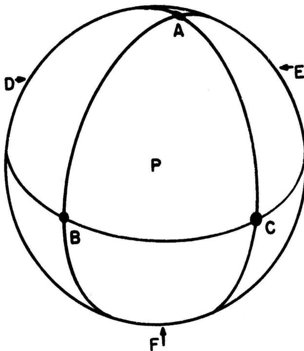
FIGURE 2.2-1. OCTAHEDRAL DISTRIBUTION OF SIX TRANSMITTING STATIONS
