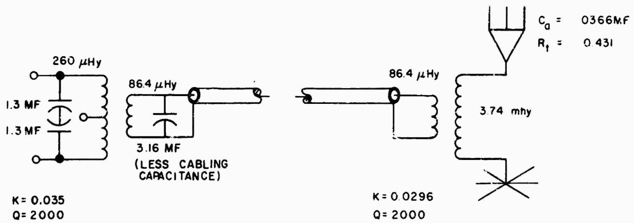
FIG. 6.5-2 REALIZED ANTENNA COUPLING CIRCUIT
