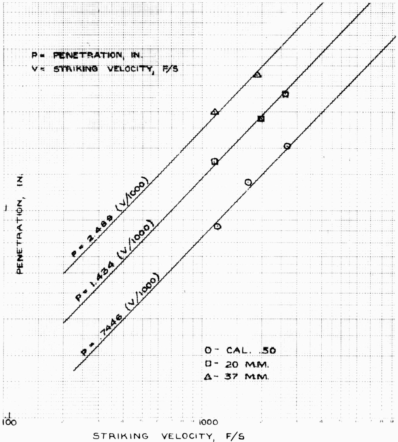
PLOT 3. PENETRATION OF VARIOUS PROJECTILES INTO QUARTZITE vs STRIKING VELOCITY (SINGLE ROUNDS)
