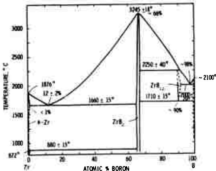
Figure 4. The Constitutional Diagram Zirconium-Boron (Rudy and Windisch)
