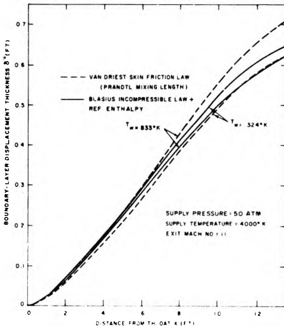
FIG 27 EFFECT OF FRICTION LAW ON NOZZLE BOUNDARY-LAYER GROWTH
