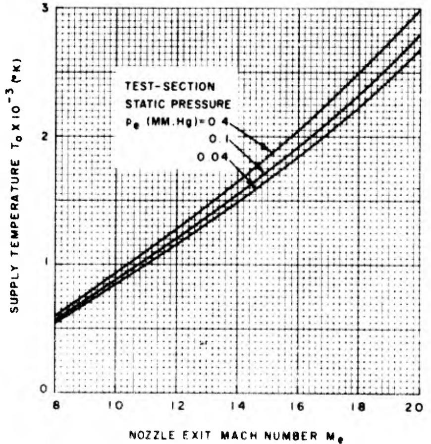
FIG 7 SUPPLY TEMPERATURE REQUIRED FOR CONDENSATION - THRESHOLD OPERATION
