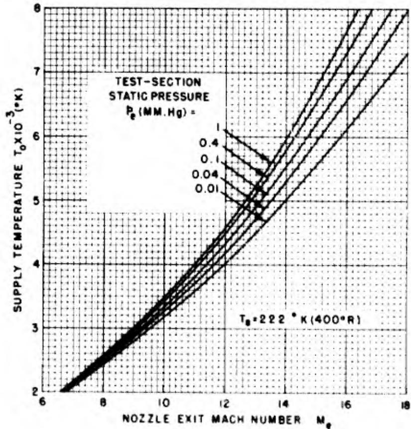
FIG 6 SUPPLY TEMPERATURE REQUIRED FOR TRUE-TEMPERATURE OPERATION
