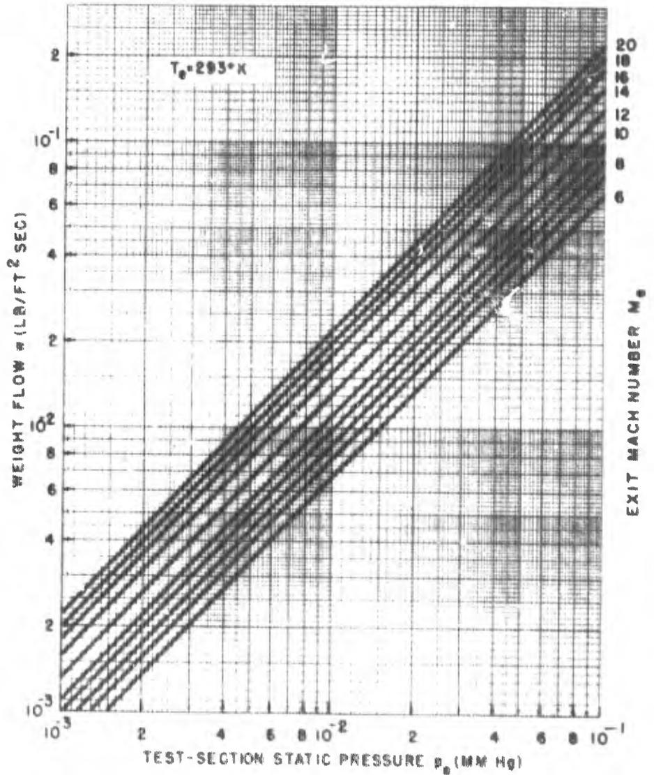
FIG 9a WEIGHT FLOW PER UNIT EXIT AREA
