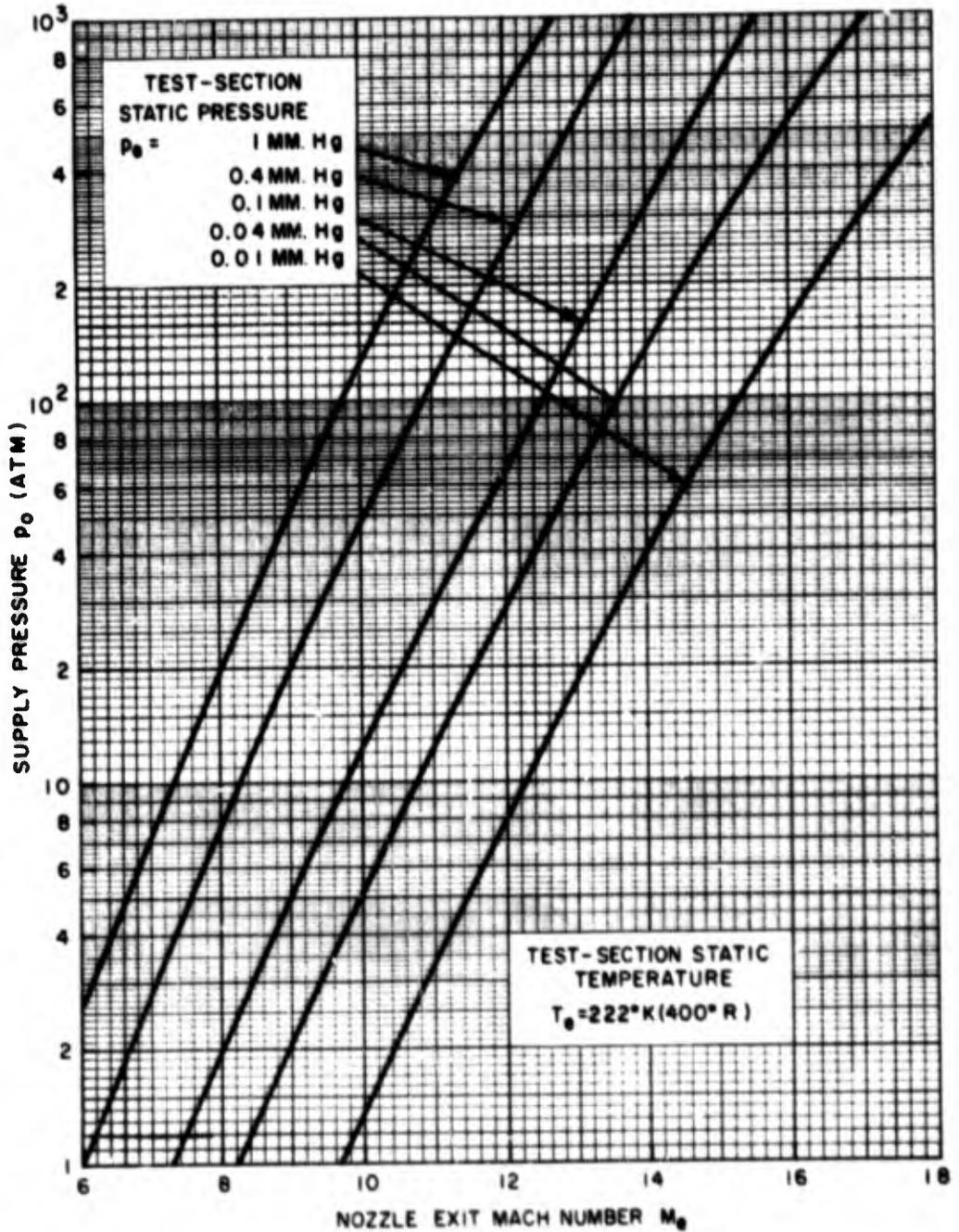
FIG. 2 SUPPLY PRESSURE REQUIRED FOR TRUE-TEMPERATURE OPERATION
