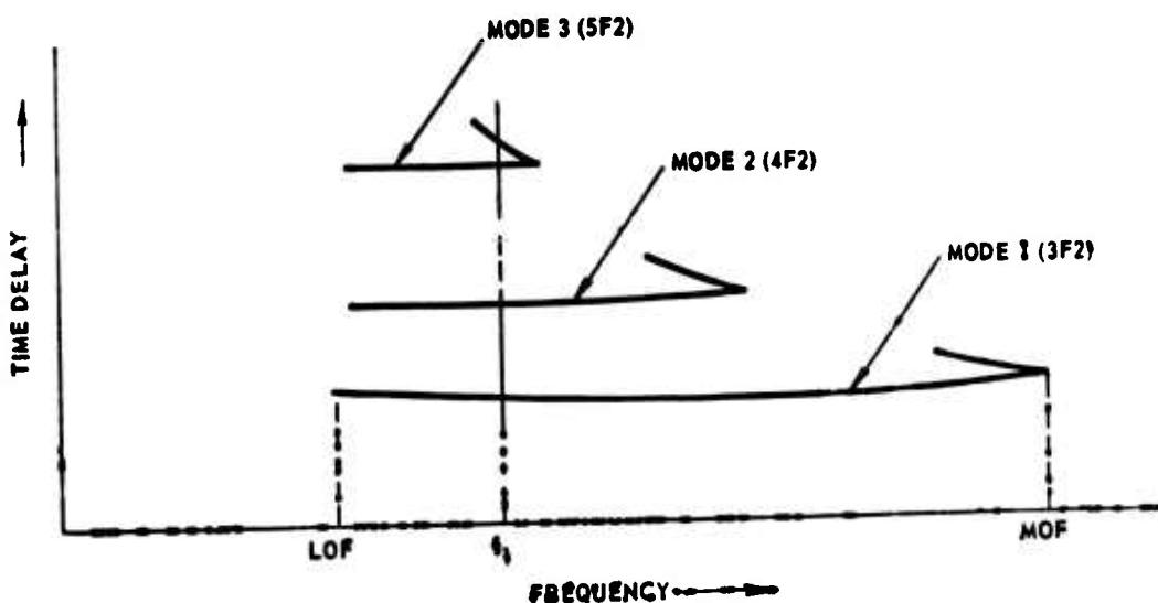
FIG. 1. THEORETICAL VERSION OF AN OBLIQUE-INCIDENCE, SWEEP-FREQUENCY IONGRAM.
