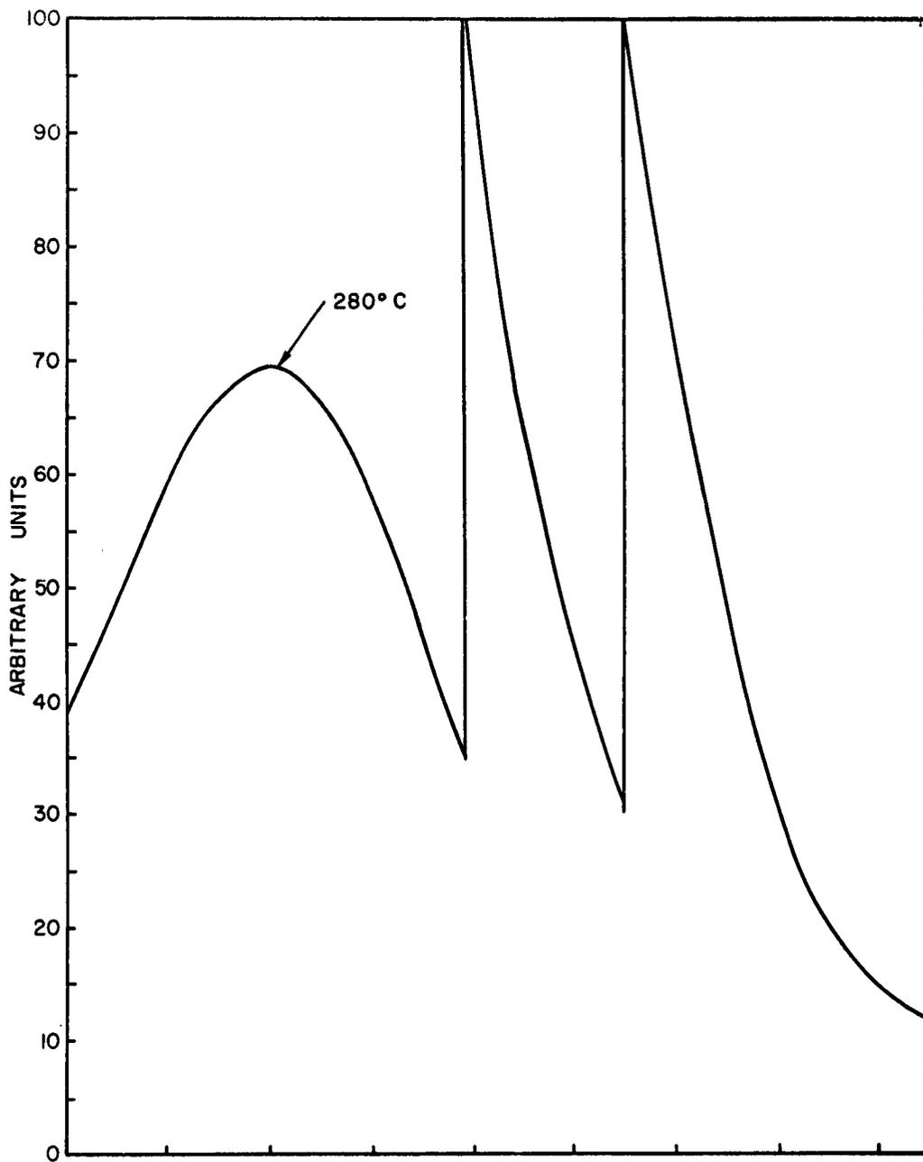
FIGURE 5. GLOW CURVE,  $\text{CaF}_2:\text{Mn}$  + CERAMIC GLAZE
