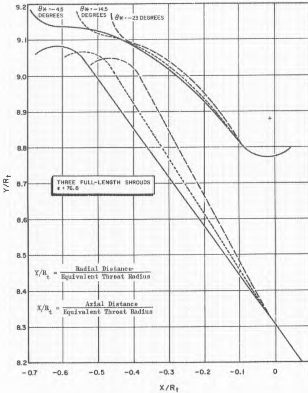
Figure 29. ADP Nozzle Contour
